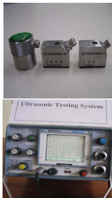
Hình 2. Các loại đầu dò và máy siêu âm khuyết tật TOKIMEC
