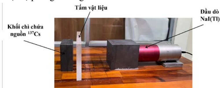
Hình 1. Sơ đồ bố trí thí nghiệm đo bề dày bằng kỹ thuật gamma truyền qua
