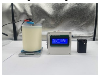
Hình 1. Bộ dụng cụ thí nghiệm đo nhiệt dung riêng
