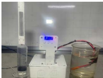
Hình 6. Bộ dụng cụ thí nghiệm khảo sát định luật Charles
