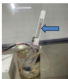
Hình 15. Xi lanh áp kế nước
