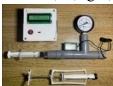
Hình 1. Bộ dụng cụ thí nghiệm khảo sát định luật Boyle
