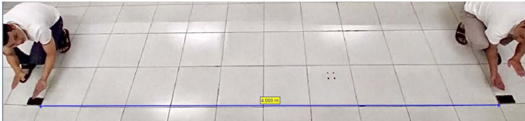
Hình 5a. Bố trí thí nghiệm đo tốc độ âm thanh trong không khí
