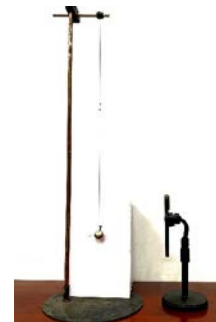
Hình 4a. Bộ thí nghiệm dao động tắt dần do lực ma sát
