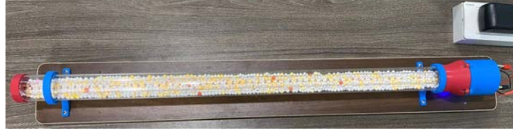
Hình 6. Bộ thí nghiệm khảo sát sóng dừng của âm thanh
